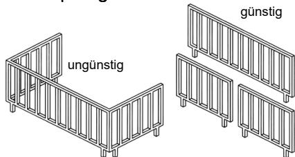
Sperrige Bauteile können zu Transport- u. Beschichtungsproblemen führen; ebene Bauteile lassen sich qualitativ besser und wirtschaftlicher beschichten. Bei Hohlräumen (z.B. Profile) sind Zulauf- u. Entlüftungsöffnungen vorzusehen.
