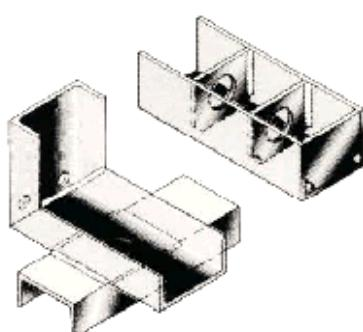
Auch bei Rahmenkonstruktionen aus offenen Profilen sind Entlüftungen und Ablaufmöglichkeiten vorzusehen.
